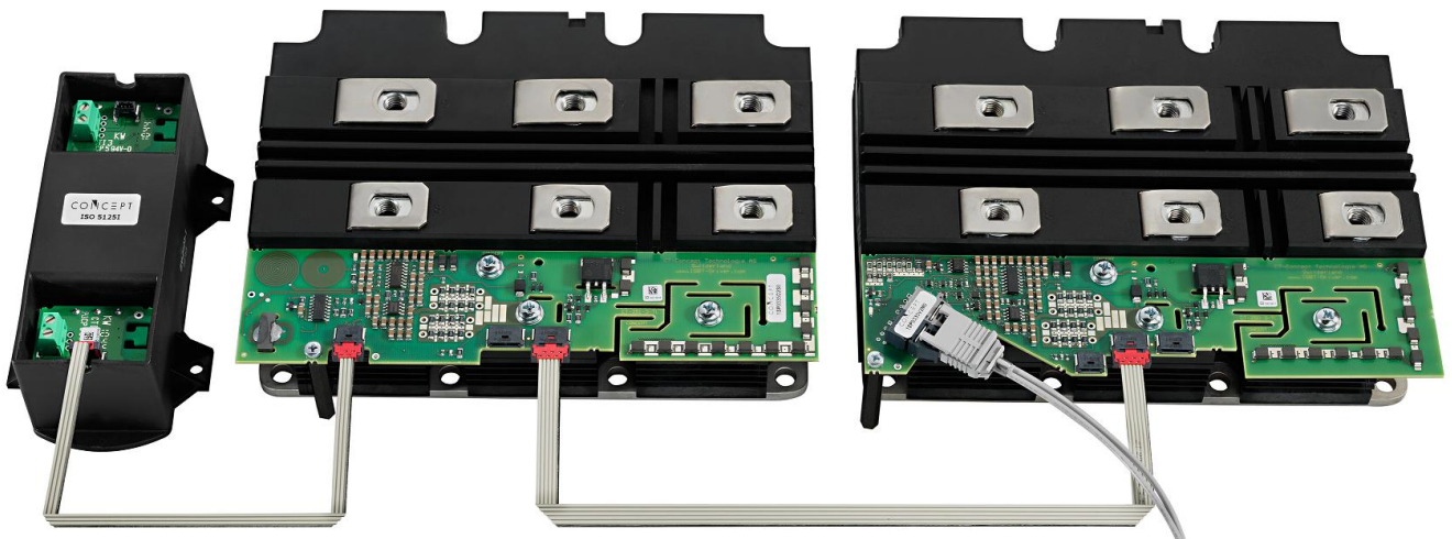
図 1 1SP0335D (スレーブ) と 1SP0335V (マスター) が 6.5kV IGBT モジュールにネジ止めされている(左: DC/DC コンバータ ISO5125I が 1SP0335D に接続されている)
