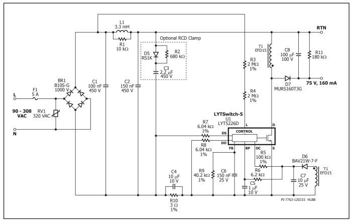
그림 5. LYT5526D를 사용한 90VAC~308VAC의 광범위한 입력 범위 용 12W, 75V, 160mA 비절연 튜브 램프 드라이버
