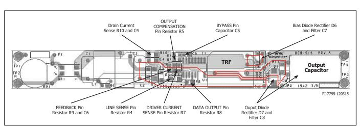
그림 6. SO-16B D 패키지를 사용하는 DER-515 PCB 레이아웃 예. PCB 레이아웃의 핵심 부품 및 루프 영역 위치를 보여줍니다
